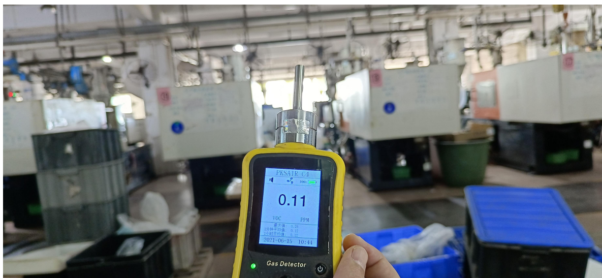
图 3.3-2 注塑车间有机物检测：VOC 为 0.11PPM
