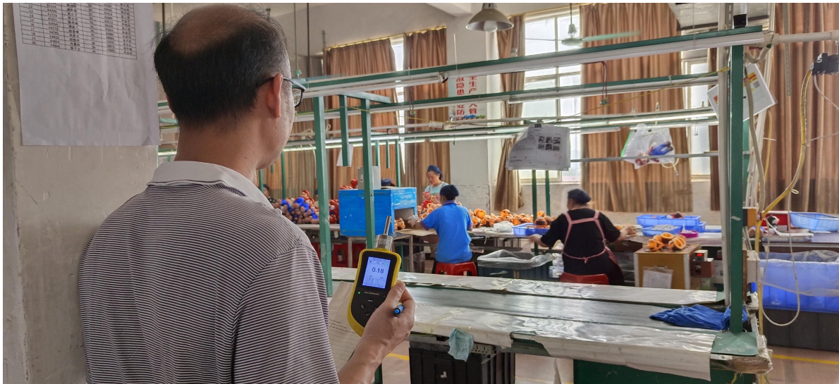
图 3.3-6 组装车间有机物检测：VOC 为 0.18PPM
