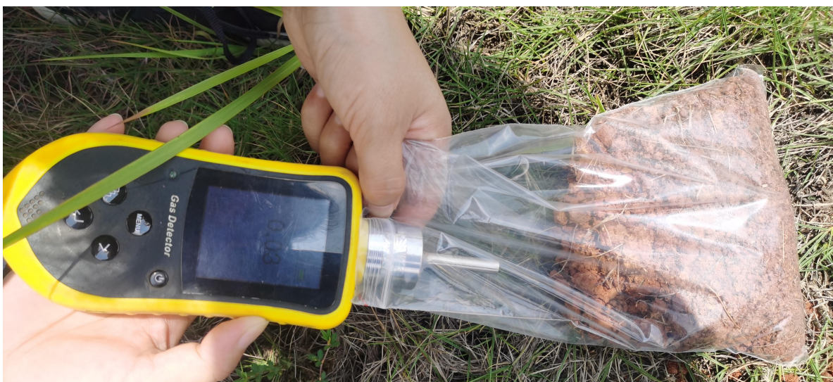
图 3.3-8 车间外土壤有机物检测：VOC 为 0.03PPM
