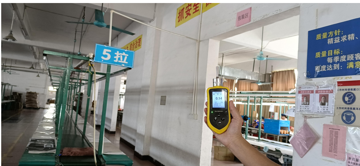
图 3.3-5 组装车间有机物检测：VOC 为 0.14PPM
