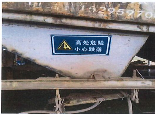
照片 11 新加部分标示标牌
